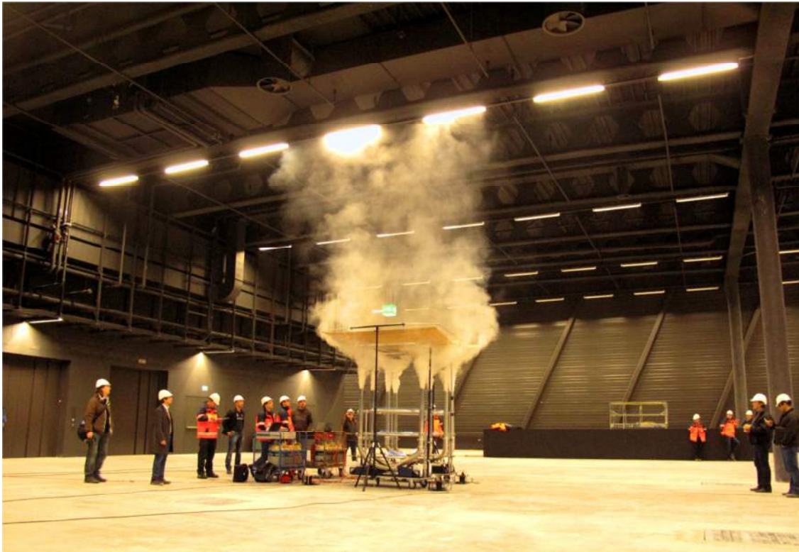
Bild 17 Warmrauchversuch in einem Hallenobergeschoss
