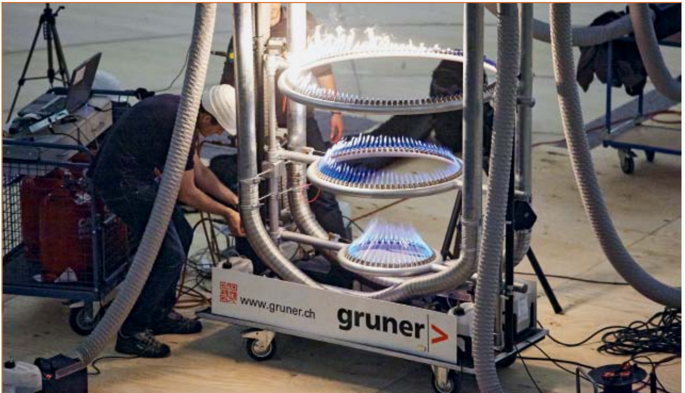
Abb. 3: Entzündung der Brennerringe – Start der Warmrauchversuche
