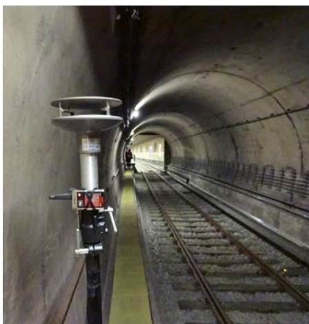
Abb. 6/7/8: Strömungsmessungen mit Ultraschallanemometer für die Strömungsanalyse, die Parametrisierung und Validierung des Simulationsmodells. Rechts: Vergleich der gemessenen und berechneten Strömungsgeschwindigkeiten an verschiedenen Orten zur Validierung der Simulation einer Zugeinfahrt.
