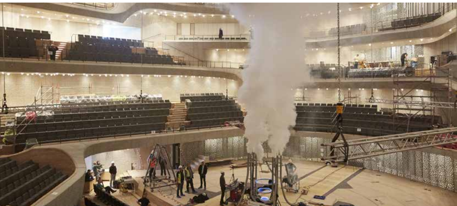
Ca.1 Min. 30 Sek. nach Versuchsbeginn, Versuchsvariante ohne automatische Aktivierung der MRWA
